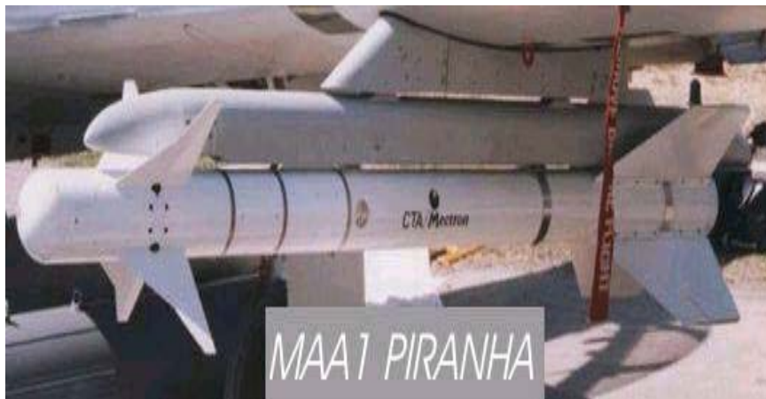
Figura 5 – Míssil termo-guiado ar-ar “Piranha”, de fabricação brasileiro
